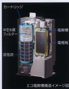
エコ電解槽構造イメージ図
